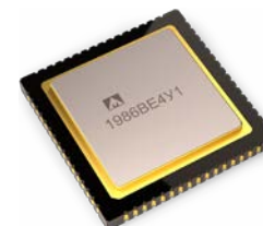
32-разрядный микроконтроллер Архитектура RISC, тактовая частота до 100 МГц
